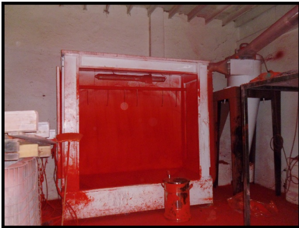
Foto 3 y 4. Cabinas de pintura con sistema de captación, extracción y control ineficientes
