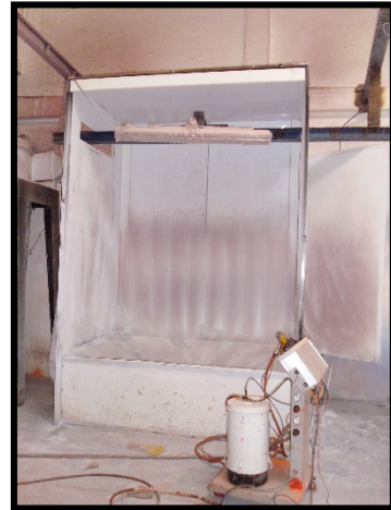
Foto 3 y 4. Cabinas de pintura con sistema de captación, extracción y control ineficientes
